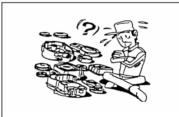
3. Ao desmontar, mantenha as peças acasaladas juntas. Isso inclui engrenagens, cilindros, pistões e outras peças que sofrem desgaste natural juntas. Peças acasaladas devem ser sempre remontadas ou substituídas em conjunto.
